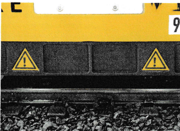
Der Arbeitsbereich der Schleifscheibe ist durch gelbe Warnschilder am Wagenkasten und im Betrieb durch die zwei (von vier) hier sichtbaren LEDs am Gleis erkennbar. Die Schleifscheibe selbst ist noch verdeckt, da ins Gehäuse eingefahren.
