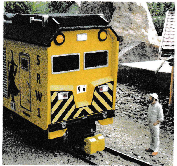
Die Beleuchtung des fiktiv gestalteten Wagens umfasst neben dem weiß/roten Lichtwechsel auch zwei gelbe LEDs, die beim Schleifprozess im Wechsel blinken.
